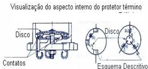
**Figura 85: Visualização do aspecto interno do protetor térmico**
