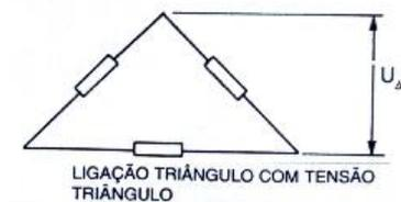
Figura 66: Ligação triângulo com tensão triângulo
