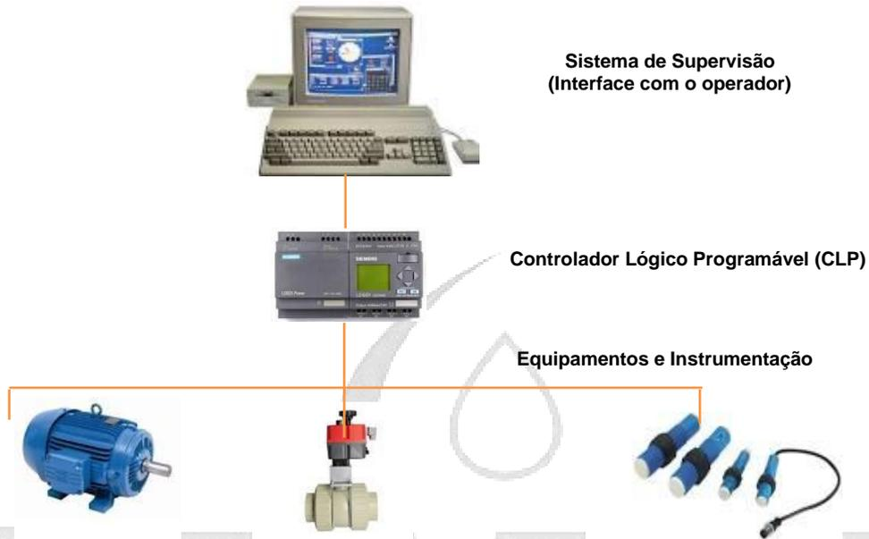
**Figura 41: Componentes básicos de um sistema de supervisão e controle**
