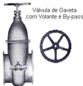
**Figura 16: Válvula com volante**
