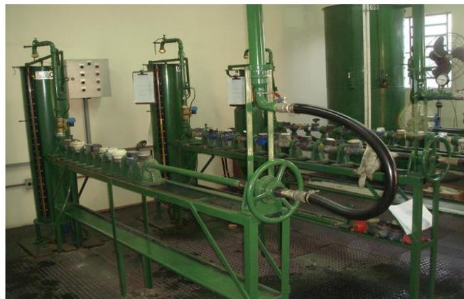
**Figura 18: Bancada de aferição**
