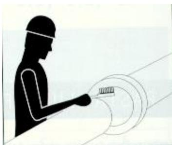
Figura 33: Limpeza para instalação de junta elástica
