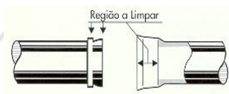
Figura 46: Limpeza da região das ponta e bolsa
