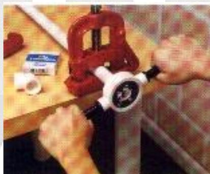
Figura 158: Encaixe do tubo na tarraxa pelo lado da guia
