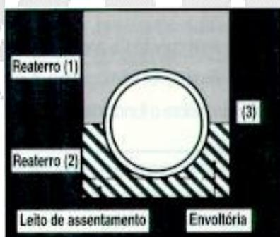
Figura 9: Reaterro em tubos rígidos e/ou semirrígidos
