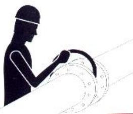
**Figura 67: Limpeza e alinhamento dos flanges**
