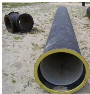
**Figura 20: Tubulação de ferro fundido**
