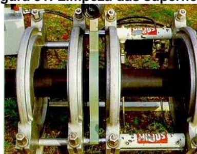
**Figura 83: Manter a placa em contato com os tubos**
