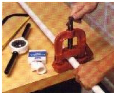
Figura 156: Fixação do tubo
