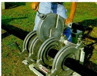
**Figura 74: Equipamento utilizado na soldagem de sela**
