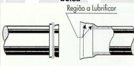
Figura 48: Aplicação do lubrificante
