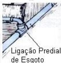
**Figura 176: Ligação predial de esgoto**
