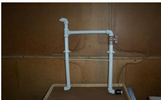
**Figura 169: Cavalete de polipropileno**
