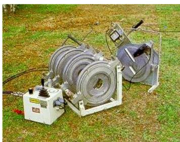
**Figura 76: Equipamento utilizado na solda de topo**
