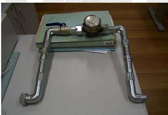
**Figura 171: Cavalete de ferro galvanizado à fogo**
